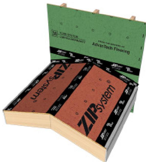
En las intersecciones de techos/muros con el revestimiento ZIP System®, aplique la cinta tapajuntas ZIP System en la proyección vertical desde donde se conecta con el techo. El ancho restante de la cinta puede adherirse a los paneles para techos ZIP System®. Extienda con rodillo la cinta adhesiva para ejercer presión sobre ella y alisar cualquier arruga.
